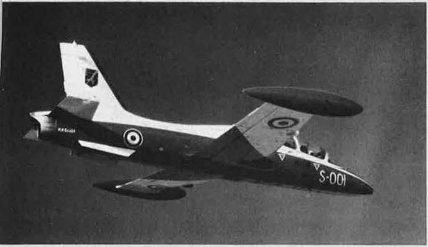
Aermacchi M.B. 339A (Rolls-Royce Viper Mk 632-43 turbojet engine)
